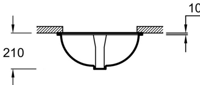
: Встраиваемая снизу раковина 49 см. E2210. Коллекция: CAXTON. РАЗМЕРЫ (СМ): 48.90x41 см. ВЕС: 9.1 кг. МАТЕРИАЛ: Огнеупорная керамика. УСТАНОВКА: Устанавливаемые снизу. ОТВЕРСТИЯ ДЛЯ СВЕРЛЕНИЯ: Без отверстия для смесителя. ОТВЕРСТИЕ ПЕРЕЛИВА: С отверстием перелива.
