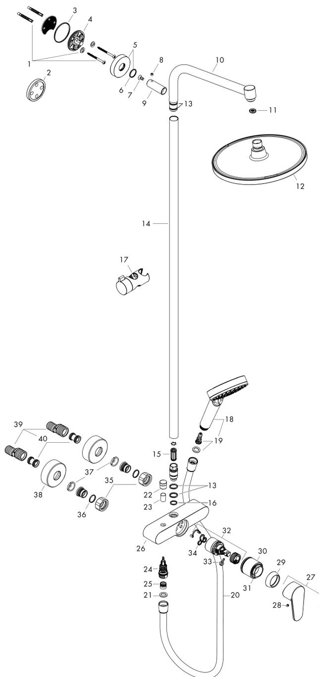
**Crometta S****Showerpipe 240 1jet с однорычажным смесителем**Поверхность: **хром** Артикульный номер: **27269000**
